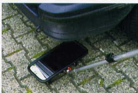
LKW Kontrollspiegel auf Rädern an einer Alu-Telekopstange
